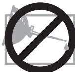
モーターの軸受は、潤滑油の補給が不要なタイプですので、絶対に注油しないでください。
