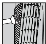
吸気口と吹出しきに付着した埃を掃除機で吸い取ってください。
