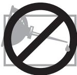
モーターの軸受は、潤滑油の補給が不要なタイプですので、絶対に注油しないでください。
